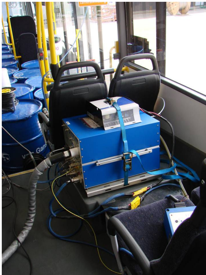
Figure 1; PEMS in de bus, samen met 15 stuks 200 ltr drums gevuld met water voor de belading van 3t.
