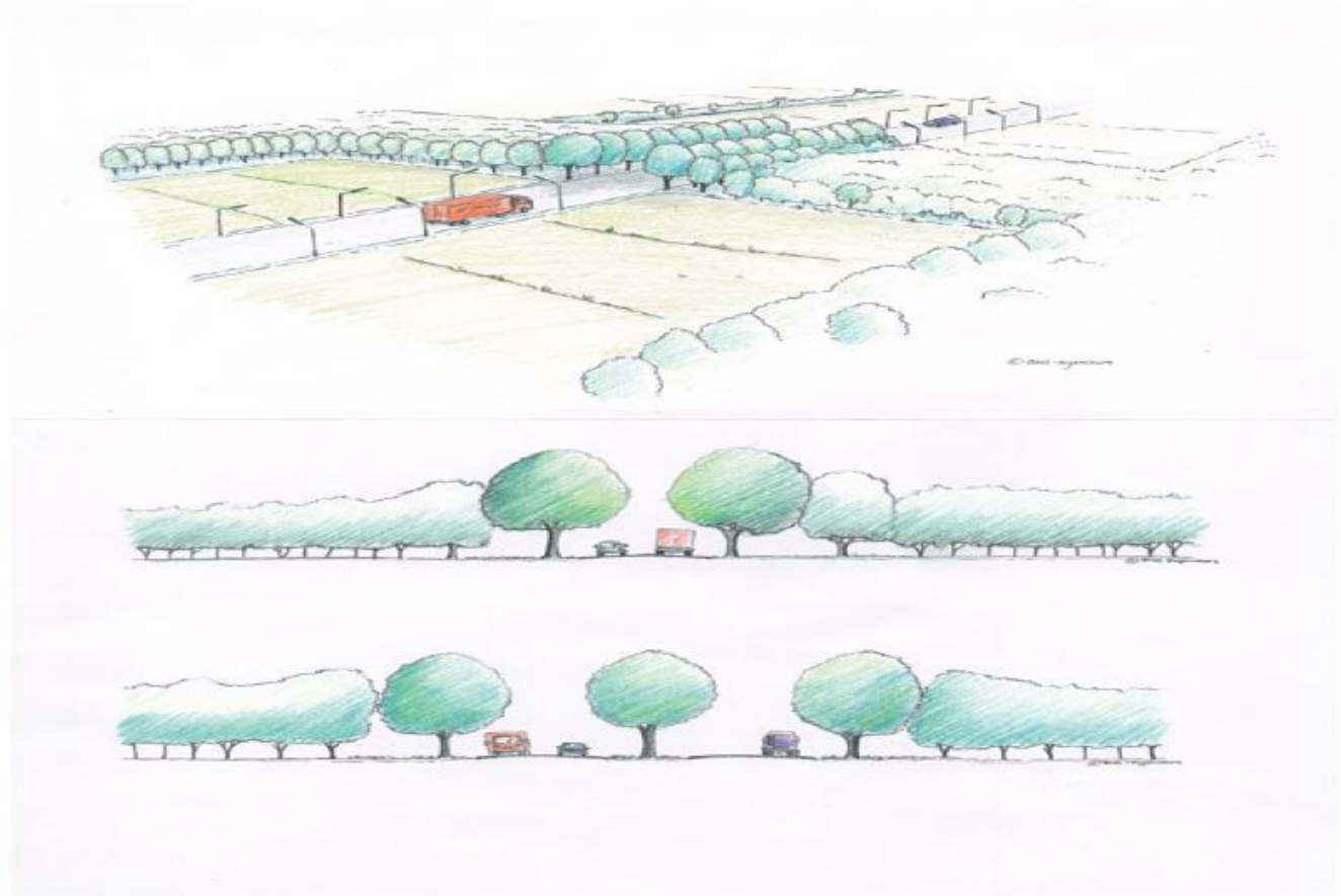
Figuur 10 Impressie hop-over voor vleermuizen met bovenstaand totaaloverzicht en onderstaand doorsnede met manier van aansluiting boomkronen met eventueel een tussenstap
